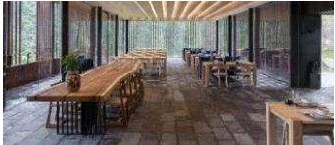
Gambar 16. Pengolahan bidang vertikal dengan sistem bukaan sebagai masuknya penghawaan alami pada bangunan di Mountain Restoran dan Bar, China. Sumber: www.archdaily.com
