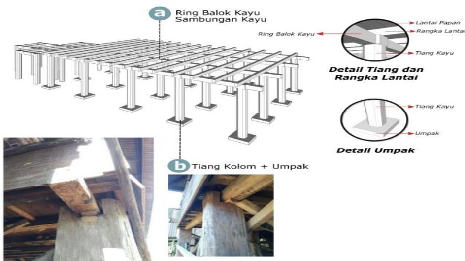
Gambar 2. Detail konstruksi dan sambungan pada bagian kaki bangunan
