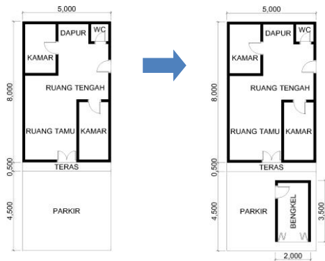
Gambar 7. Denah Perubahan Bangunan Homestay Cileunca Sumber : Hasil Analisis, 2018
