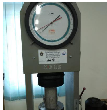
Gambar 6. Alat yang digunakan untuk uji kuat tekan
