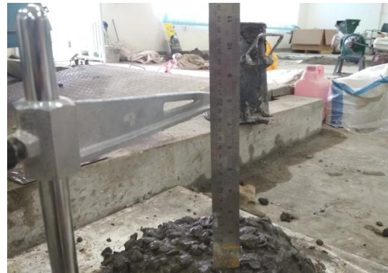
Gambar 8. Hasil Pengujian Slump
