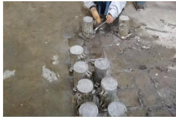
Gambar 4. Proses pengeluaran beton dari bekisting
