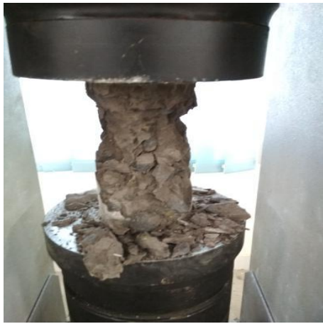
Gambar 12. Uji kuat tekan beton
