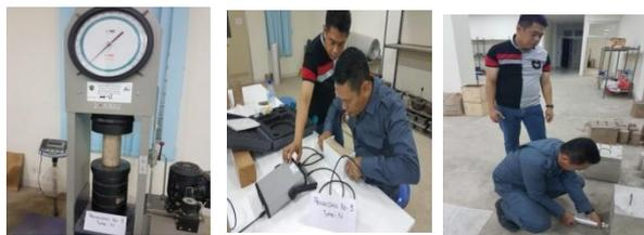
Gambar 2. Proses pengujian kekuatan beton benda uji dengan alat Universal Testing Machine (UTM) dan Ultrasonic Pulse Velocity (UPV) serta alat Hummer Test
