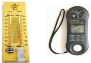
**Gambar 1.** Alat ukur temperatur udara dan kelajuan aliran angin
