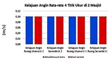
**Gambar 10.** Kelajuan aliran udara pada 4 titik ukur di masjid pusat kota dan masjid pesisir dari pukul 06.00-18.00
