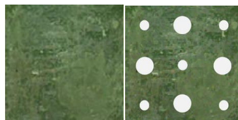
Gambar 6. Produk yang dihasilkan bahan dinding alternatif polos dan berlobang
