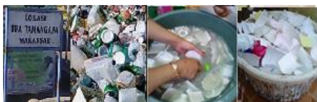
Gambar 2. Sampah plastik melalui proses pencucian dan pengeringan
