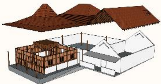
Gambar 7. Rancangan atap bangunan.
