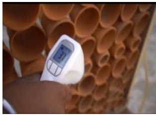
Gambar 7. Pengukuran suhu sebelum dialiri air
