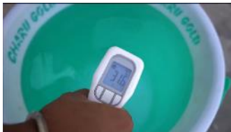
Gambar 8. Pengukuran suhu air
