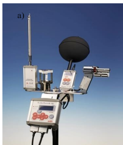
Gambar 3. (a) LSI-LASTEM Multi Logger dan (b) HOB0 data logger, serta (c) HOB0 data logger dengan sensor eksternal.
