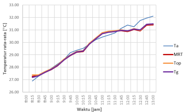
Gambar 4. Profil temperatur udara (Ta) [°C], MRT [°C], Temperatur operatif (Top) [°C], dan Temperatur globe (Tg) [°C].
