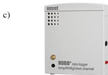
Gambar 3. (a) LSI-LASTEM Multi Logger dan (b) HOB0 data logger, serta (c) HOB0 data logger dengan sensor eksternal.
