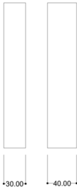
Gambar 6 Dua macam ketebalan shearwall yang digunakan
