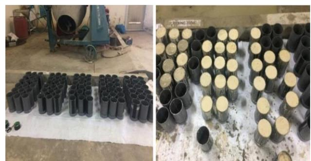
**Gambar 5.** Pengisian beton kedalam cetakan.
