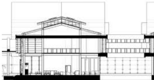
**Gambar 10.** ventilasi silang pada bangunan untuk mendapatkan penghawaan alami dan meminimalisir penggunaan energi tak terbarukan.
